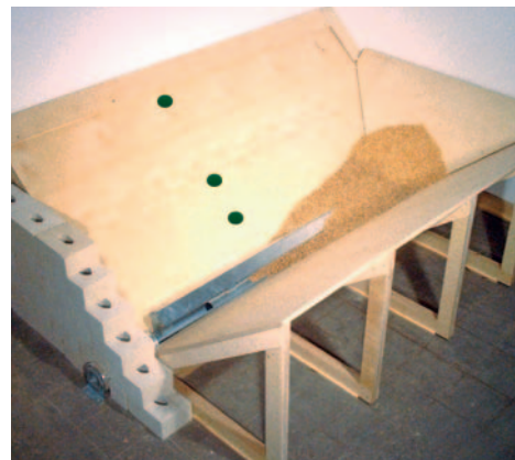
Abb. 25 Drucksensoren zur Füllstandsmessung im Schrägbodenlager
